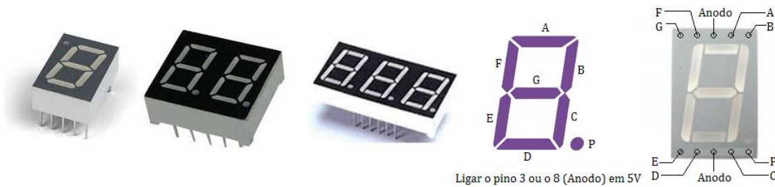
Figura 3 – Exemplos de mostradores (em inglês displays) de 7 segmentos e sua nomenclatura.
