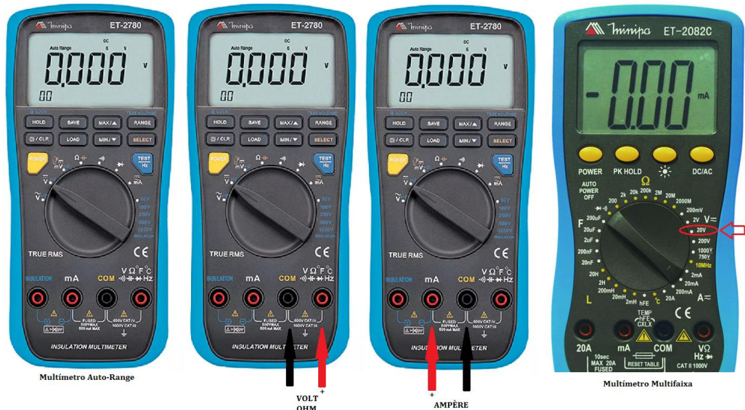
Figura 1 – Exemplos de multímetros e de uso dos seus terminais para medidas específicas.
